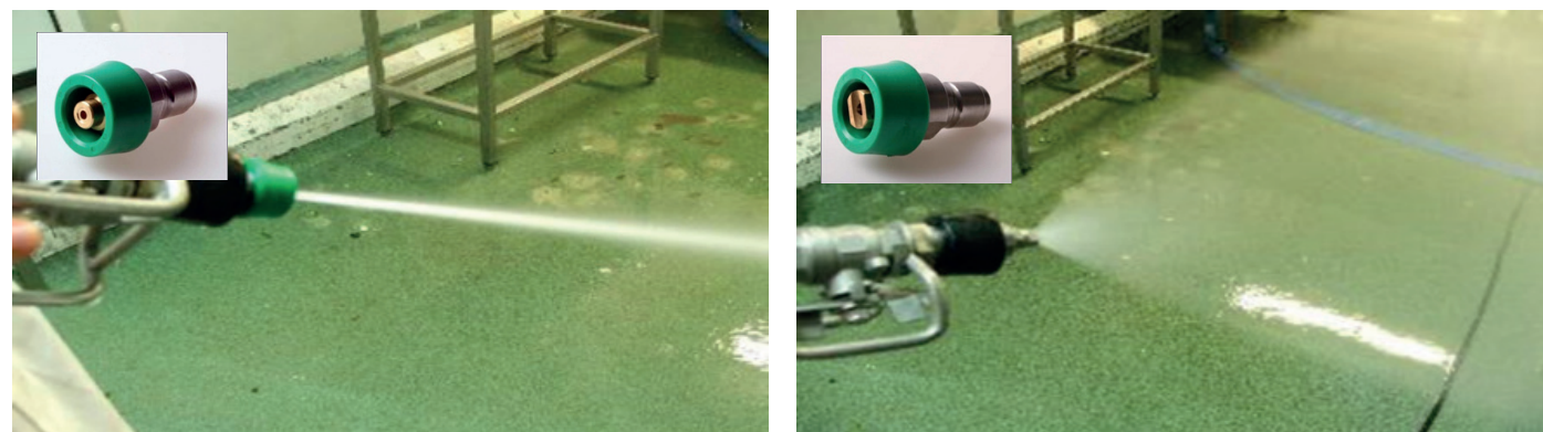
Photo 11 La consistance de la mousse et choix de la buse pour l'utilisation du canon à mousse (CTCPA).
