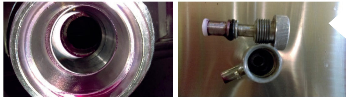
Photos 14 et 15 Démontage de 2 points critiques (vanne et dégustateur) avant procédure (IFV 2018)
