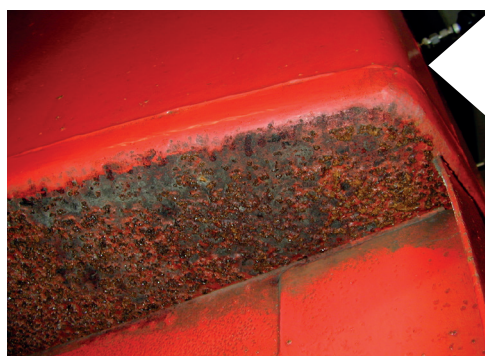
Photo 1 Encrassement par corrosion (P.Poupault)
