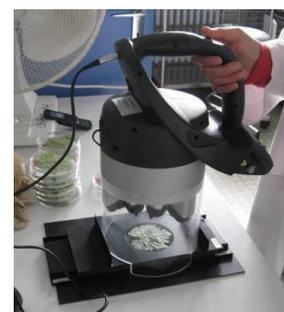
**OBJECTIF DES ESSAIS :** détecter un changement d'état de la vigne suite à l'application d'une substance SDN, c'est-à-dire un changement ou une évolution significative d'un des indices mesurés par le Multiplex.
