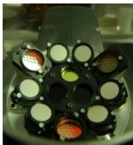
Le Multiplex est un capteur optique portable développé par la société Force A. Il mesure le taux de certaines molécules contenues dans les tissus végétaux en utilisant la fluorescence (émissions de certaines longueurs d'ondes d'excitation et mesures en retour de différentes réponses de fluorescence). Il est déjà développé pour mesurer la nutrition azotée sur grandes cultures ou gazon et la maturité phénolique du raisin.
