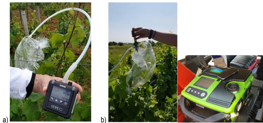
Figure 5 : Collecte dynamique (sous aspiration) des COVs au vignoble : a) sur capteur Tenax®, à l'intérieur du sac et relié à une pompe manuelle b) sur NeedleTrap, à l'intérieur du sac et relié à une pompe manuelle) avant désorption et analyse in situ sur GC-MS portable (Torion PerkinElmer) (essai Bourgogne UMR AE 2019)
