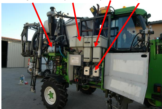
Mini cuve de mélange Cuves de liquide Cuves de poudre Doseurs poudre
