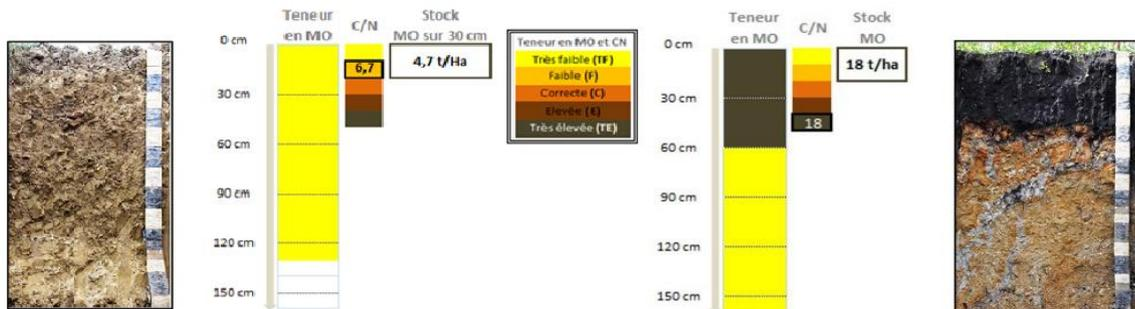
Figure 3: Profils organiques d'un sol argileux carbonaté (gauche) et d'un sol sablo-graveleux acide (droite).
