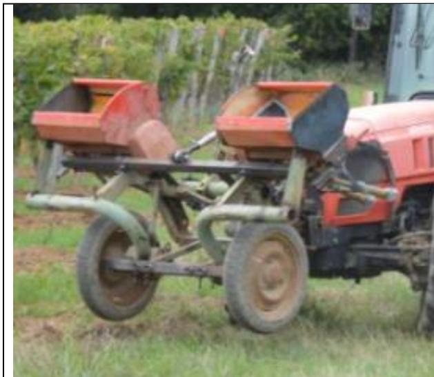
Semoir à la volée : auto construit par le viticulteur
