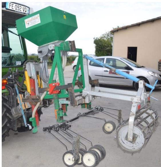
Semoir à la volée : auto construit par le viticulteur avec le soutien technique de la CA33.
