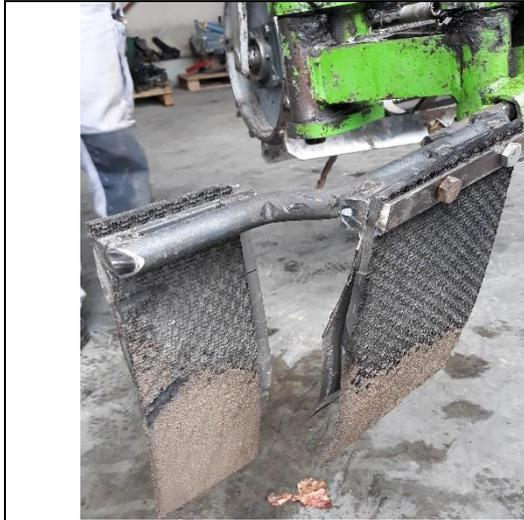
Elaboration de deux prototypes pour le rappuyage des graines qui était le point d'amélioration à apporter aux semoirs sous le rang.
